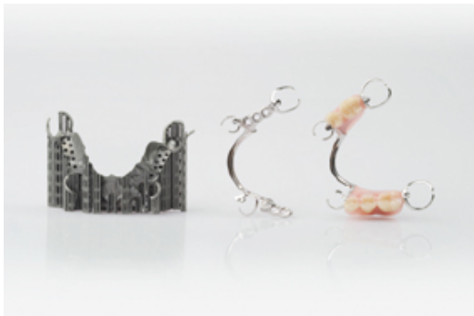
Herausnehmbarer Zahnersatz per digitaler Modellguss-Technologie in 3 Prozessschritten
