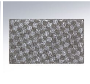
► BELICHTUNGSMUSTER (Schachbrett-Prinzip) von der EOS Eosint M270
