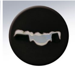
► SCHLIFFBILD einer vollverblendeten Brücke aus EOS CoCr SP2
